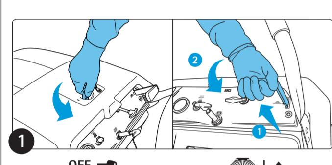
RU Установить машину в нерабочее положение, повернув ключ в положение OFF (выкл.) и подняв боковые щетки
